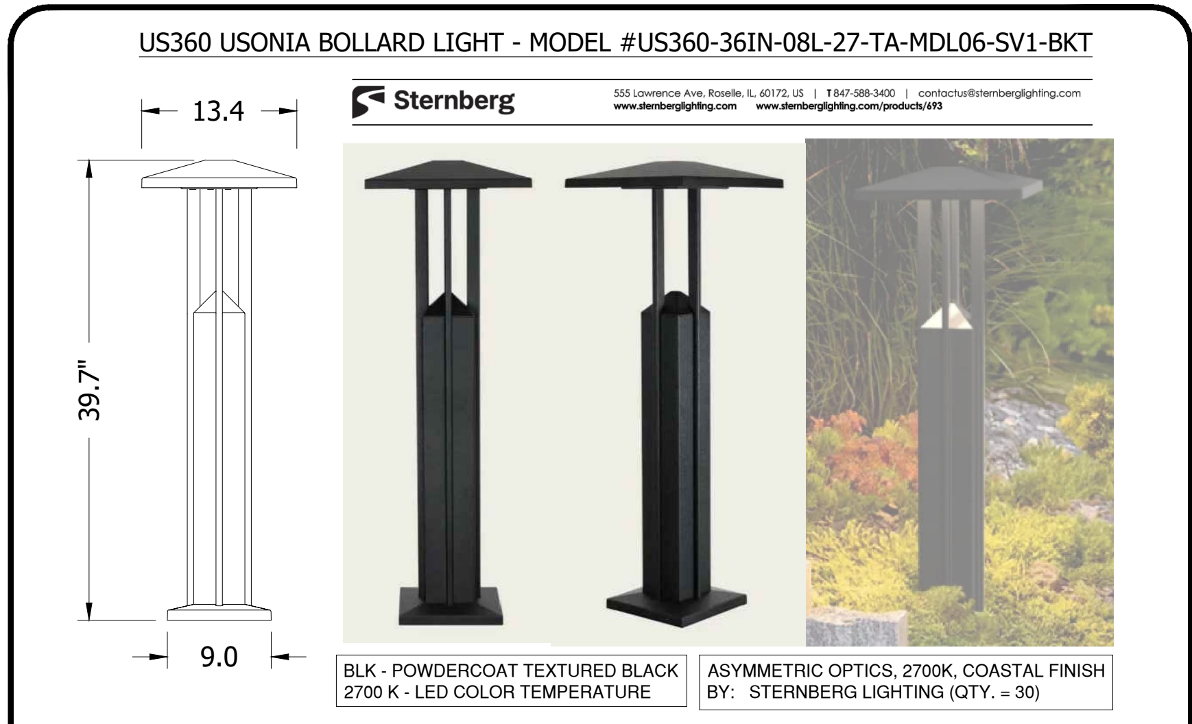
BOLLARD LIGHT DETAIL BY: STERNBERG - USONIA BOLLARD QTY: 30 N.T.S.
